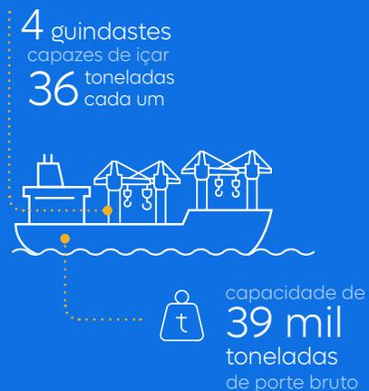
Para reforçar nossa frota, adquirimos em 2024 uma nova embarcação: o **Babitonga Bay**. Construído em 2015, trata-se de um navio multipropósito do tipo *handysize* (médio porte), com foco no transporte de produtos siderúrgicos e capacidade de até 39 mil toneladas de porte bruto. Conta com cinco porões de carga e quatro guindastes, cada um com capacidade para içar até 36 toneladas, para atender à nossa crescente demanda logística.
